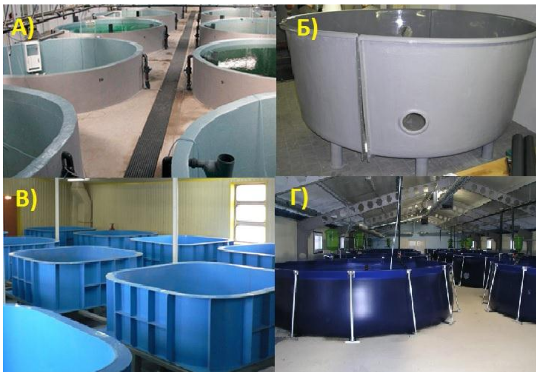
А – бетон; Б – стеклопластик; В – полипропилен; Г – прорезиненная ткань
