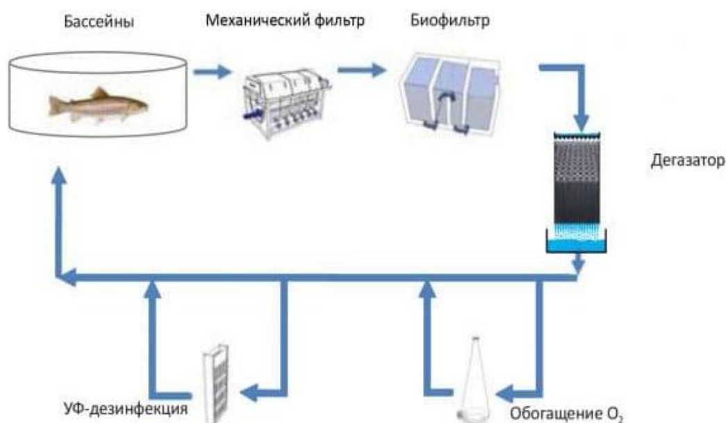
Рисунок 2.16. – Схема движения воды в УЗВ
