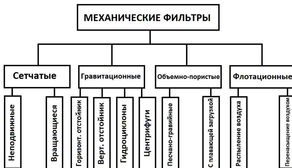
Рисунок 2.4. – Классификация механических фильтров по способу отделения осадка
